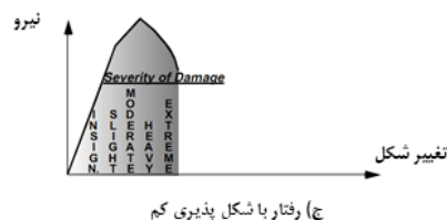
شکل (پ-۳-۳): منحنی رفتار اعضا با شکل‌پذیری‌های متفاوت
