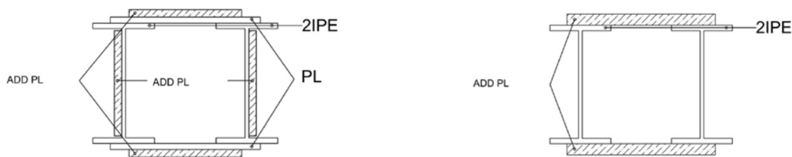
شکل (۲-۴۱): نمایی از جزئیات چند نمونه تقویت ستون
